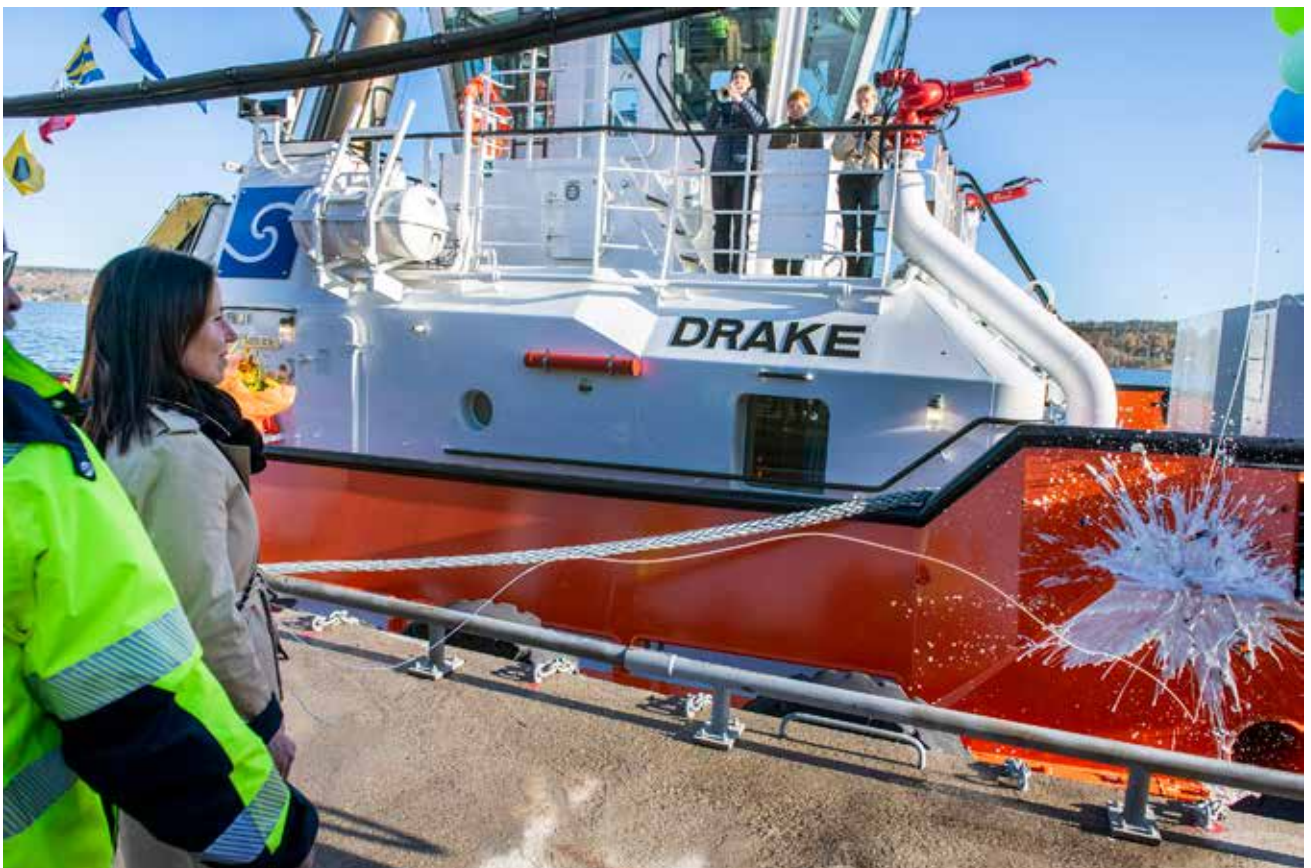
Båten har hög dragkraft (60 ton), använder fossilfritt bränsle och har isbrytarkapacitet. Bild från dopceremonin med Charlotte Kalla till vänster i bild. Foto: Eva-Lena Olsson/Sundsvalls Tidning.
