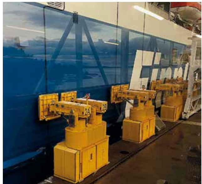
Kajens vaccumstativ som kan klättra efter fartygssidan vid lastning och lossning.
