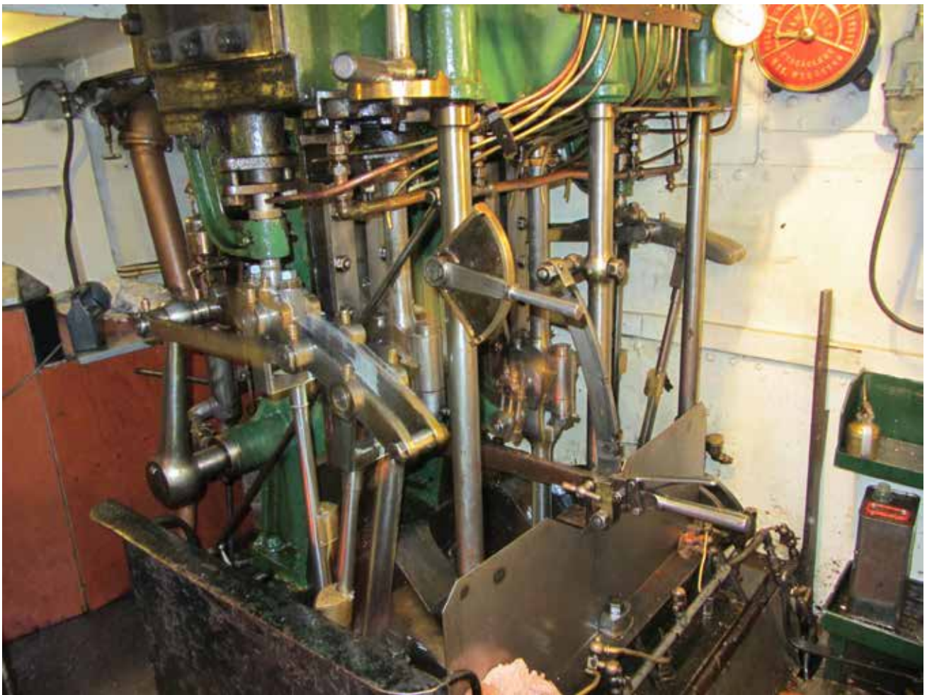
Ångmaskinen på S/S Östersund. En tvåcylindrig compoundångmaskin tillverkad vid Härnösands mekaniska verkstad 1903. Ca 120 hkr som ger en fart på ca 8 knop.
