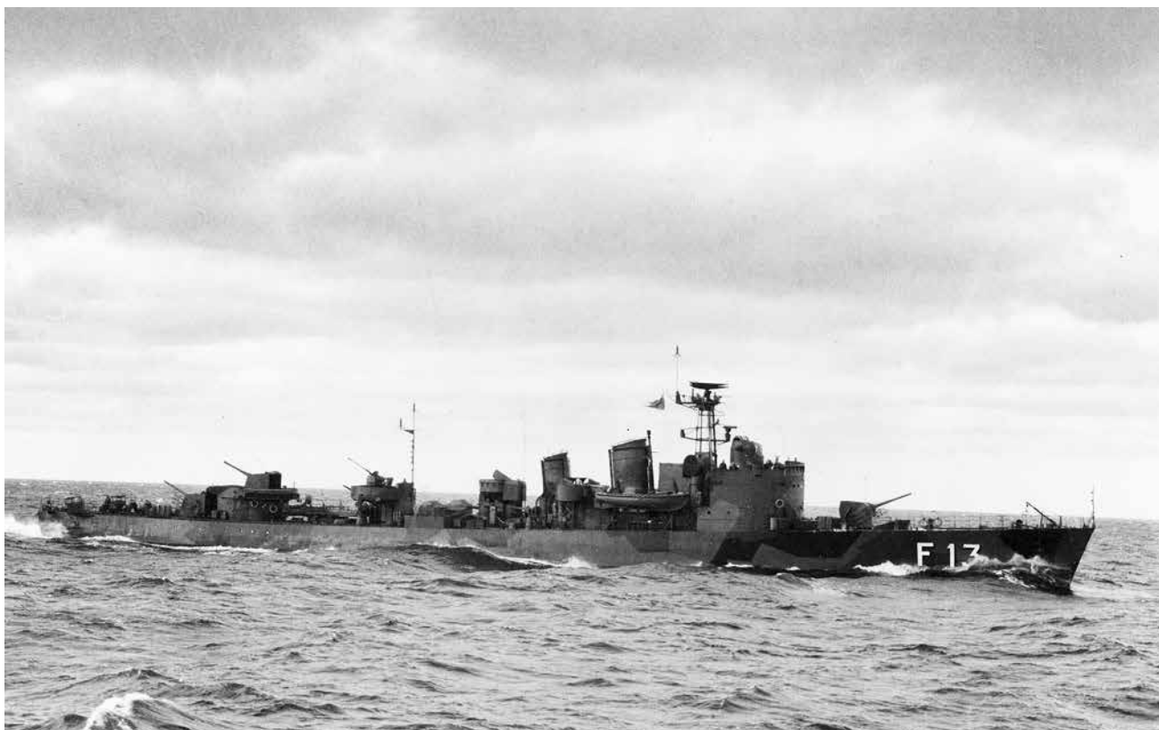
HMS Hälsingborg efter ombyggnad från jagare till fregatt. Bredd över allt 9,2 meter, längd över allt 97,5 meter. Maskinstyrka 36000 ind hkr Reg. Nr.: F13 Rederi: Kungliga Flottan, Marinen. Byggår: 1943. Foto: 1968 Sjöhistoriska museet/Marinens Pressdetalj/MPD/Fo11276A.
