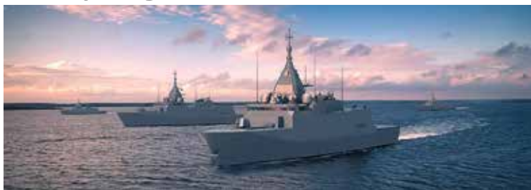
Finska fregatter (i Finland kallade korvetter) av Pohjanmaa-klass. Längd 117 meter, bredd 16 meter, djupgående 5 meter, displacement 4 300 ton, fart ca 26 knop, aktionsdistans 2 500 distansminuter. Bild: Rauma Marine Constructions.
