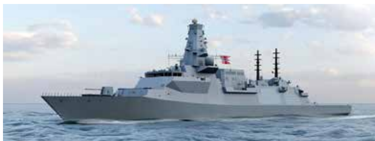
Norska fregatter av brittisk "Type 26-klass". Längd 149,9 meter, bredd 20,8 meter, displacement 6 900 ton, fart 26+ knop, aktionsdistans 7 000 distansminuter. Bild: Forsvaret, Norge.
