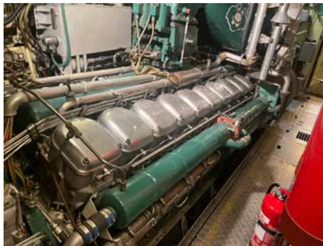
En cylinderrad på styrbords huvudmotor (MTU 672, V20) på HMS Hugin.
