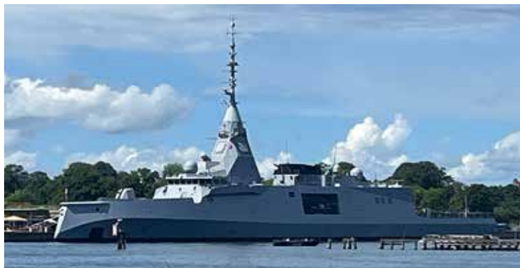
Blivade svensk fregatt av FDI-typ. Längd 122 meter, bredd 17,7 meter, displacement 4 460 ton, fart 27 knop, aktionsdistans 5 000 distansminuter. Foto: Thomas Engevall
